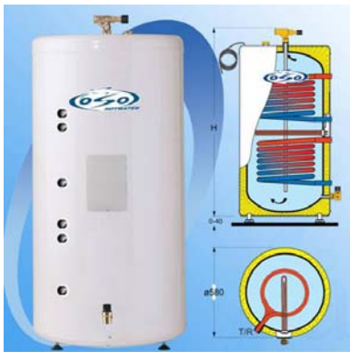
Figur 10. Varmtvannstank RTV300VE fra OSO for tilkobling til solvarme (i bunnen) og gass (i toppen). Finnes i størrelser på 200 og 300 liter. www.oso.no .
